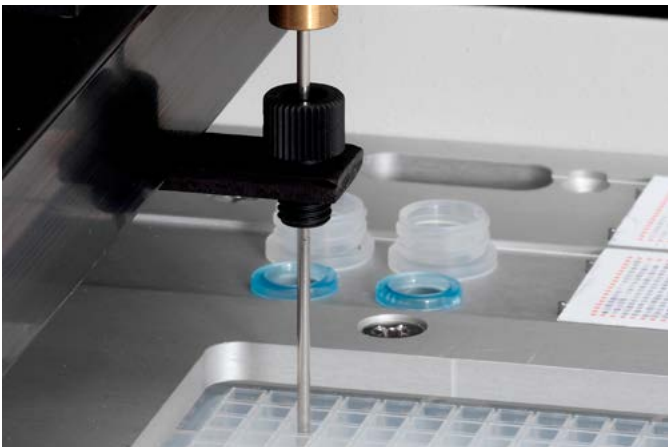
Spotting von gelösten Peptid-Cellulose-Konjugaten in einer 384-Well-Filterplatte, die auf CelluSpots-Objektträger aufgetragen werden.
